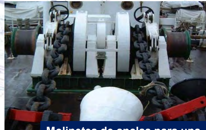
Molinetes de anclas para una o dos líneas
