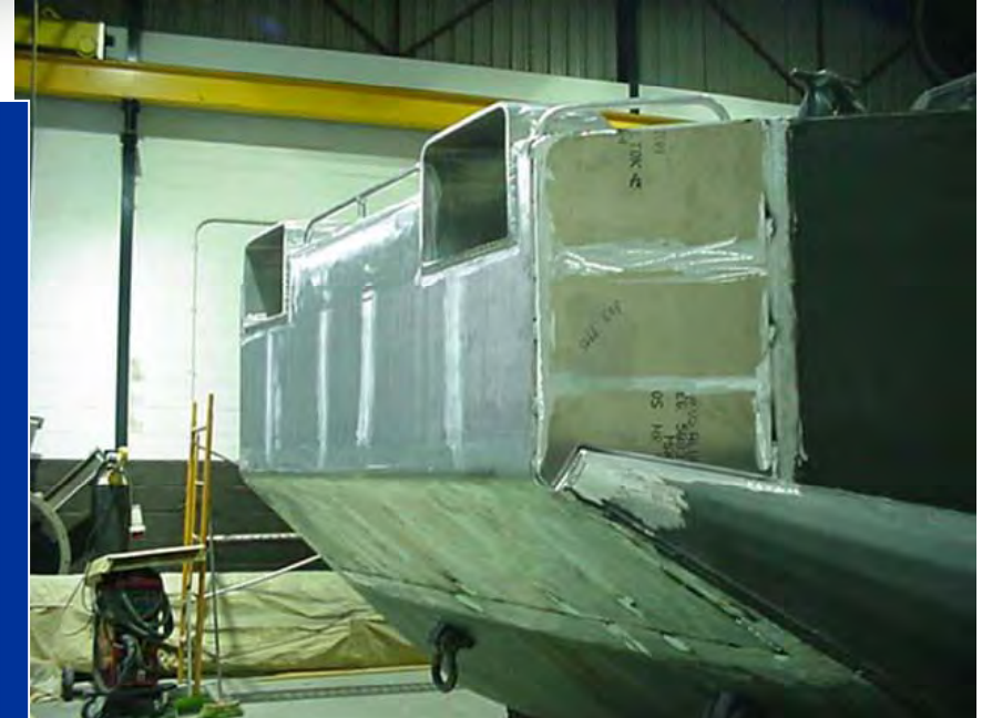
Fabricación de proa vehículo AAV
